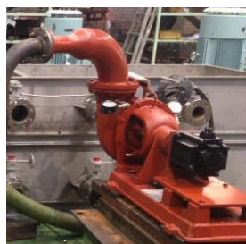
図1 製作した水車発電システム
