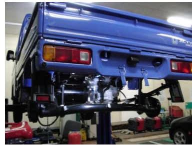
図6 車両に搭載されたパワーユニット
