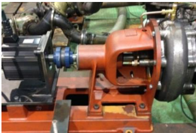
図1 製作した水車発電システム
