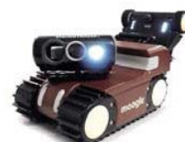
自走式床下点検ロボット
