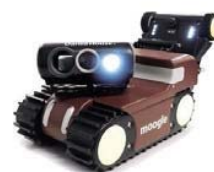
自走式床下点検ロボット
