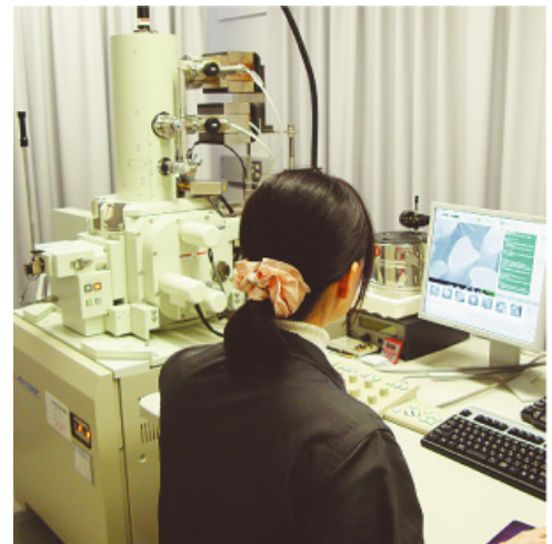
高精度の顕微鏡で異物を検査
