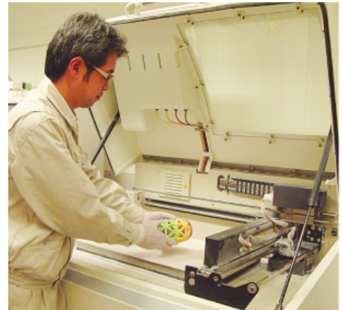
3D試作機で、開発中の製品の型を作成
