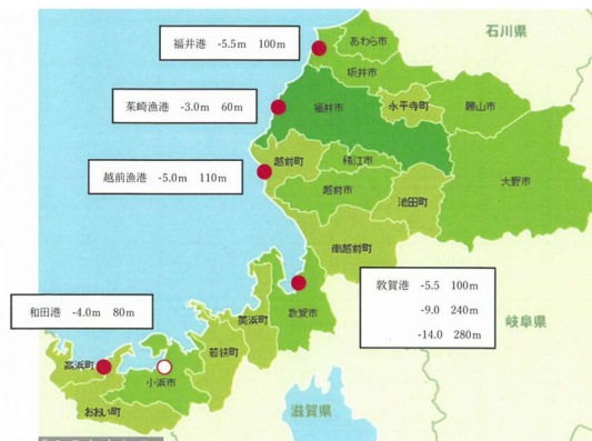
県内の耐震岸壁整備状況
